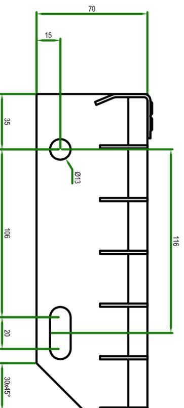
Gitterroststufe 250 mm Auftritt - SONDER
