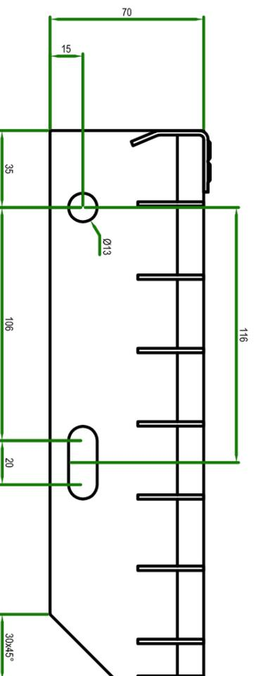
Gitterroststufe 270 mm Auftritt lt. DIN24531
