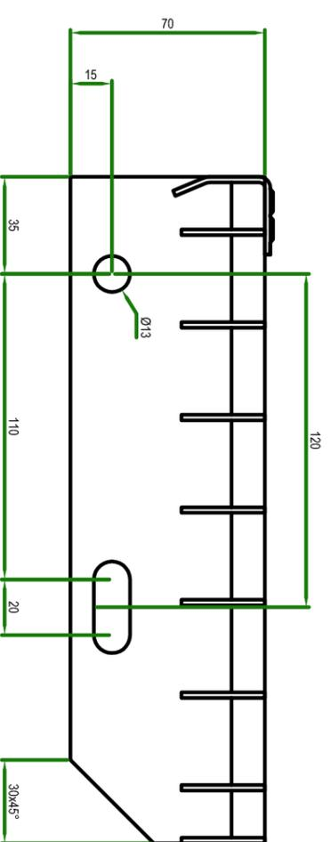
Gitterroststufe 305 mm Auftritt lt. DIN24531
